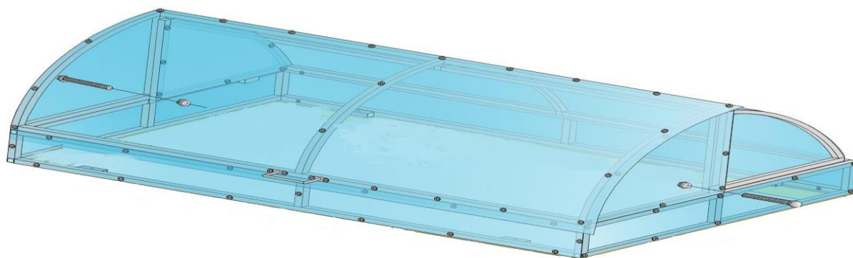
Рис. №9 Соединение нижней части теплицы с большой и малой дверью осевыми винтами М6*60
