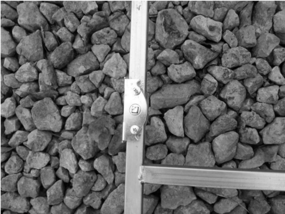
Рис. 2 Крепление завертки в двери
