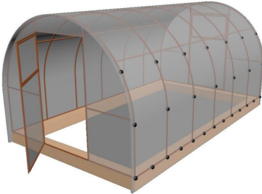
Рис. 8. Места крепления поликарбоната саморезами
